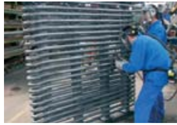
Fertigung einer Kühl- und Heizschlange
